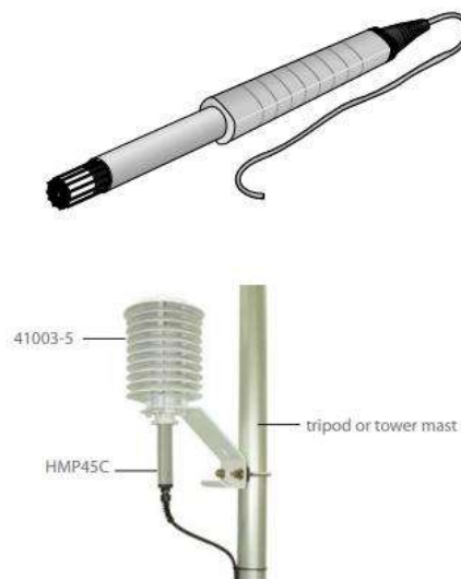
Figura 3.5 - Sensor de Temperatura e Umidade de Alta Performance.
