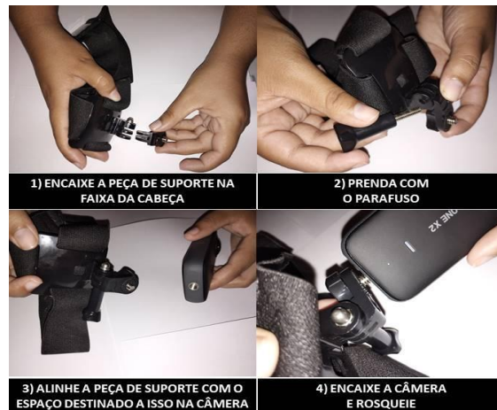
Figura 2 - Passo a passo do encaixe da câmera no suporte de cabeça. Redenção, CE, Brasil, 2024
