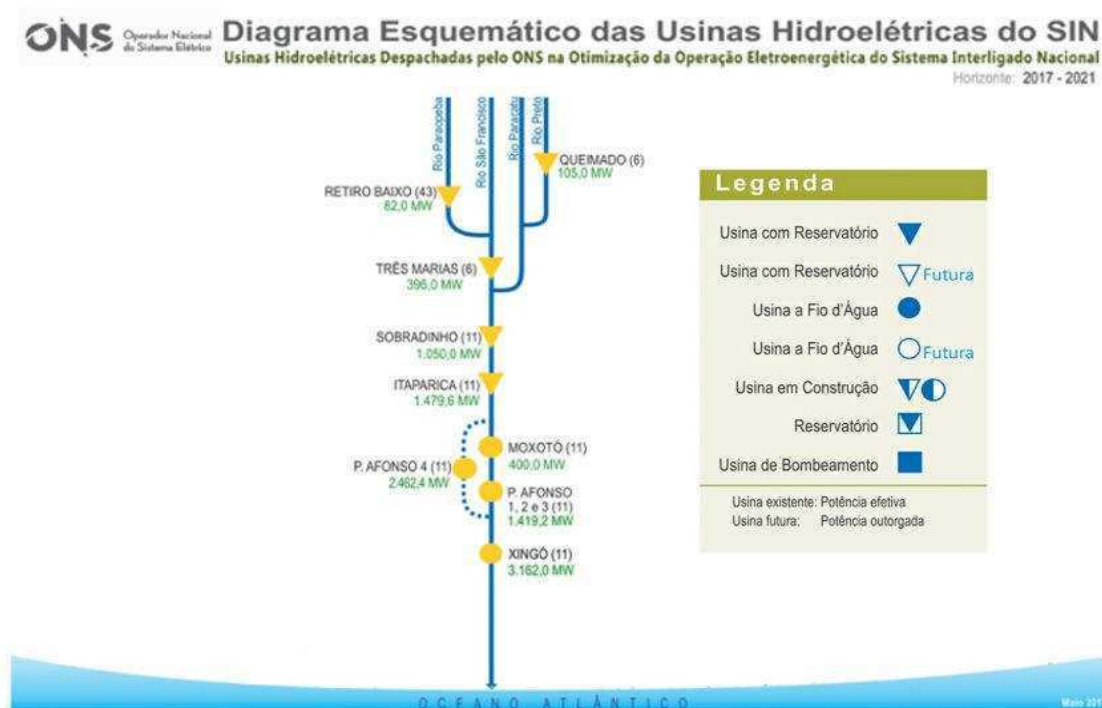
Figura 2.12 - Diagrama unifilar das UHEs pertencentes à Bacia do Rio São Francisco.
